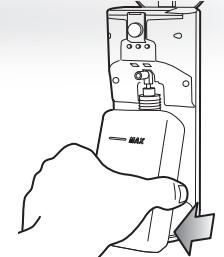
① 右図のようにボトルの底側から持ち上げてボトルを外します。
