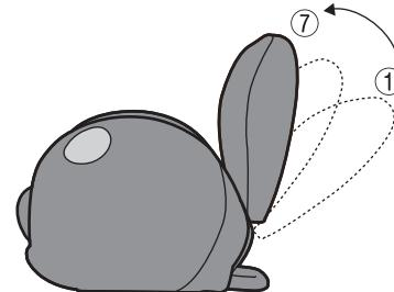
下図の矢印のように背を⑦より前方に倒すとギアがはずれ①の位置に戻ります。
