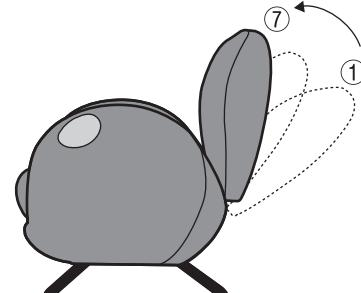
下図の矢印のように背を⑦より前方に倒すとギアがはずれ①の位置に戻ります。
