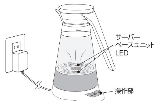
電源ボタンを連続して3回押すか、水素生成中に電源ボタンを押すと（「ピピッ」というブザーが鳴ります）、電源を「OFF」にし、水素生成を停止させることができます。
