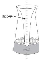
取っ手の先端がサーバーベースユニットのブランドロゴの中心位の位置にくるようにしっかりと閉めてください
