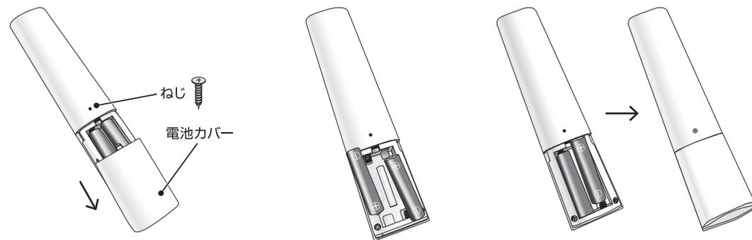
① リモコン裏面の電池カバーを開ける。
