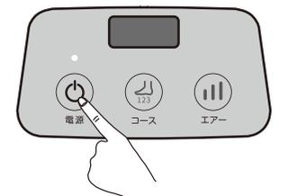
操作パネルの電源ボタン(停止ボタン)を押してください。その場で動作が停止します。
