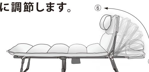
右図の矢印のように背を⑥より前方へ倒すと、ギアがはずれ元の位置に戻ります。
