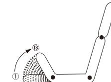
右図の矢印のように背を④より前方へ倒すと、ギアがはずれ元の位置に戻ります。元の位置に戻す際に前方へ傾ける事で角度調節も出来ます。
