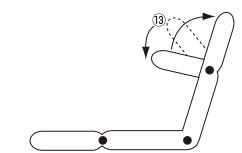
また、右図の矢印のように頭を⑬より前方へ倒すと、ギアがはずれ元の位置に戻ります。
