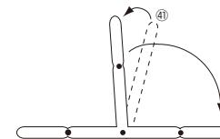
また、右図の矢印のように頭を⑬より先方へ倒すと、ギアがはずれ元の位置に戻ります。
